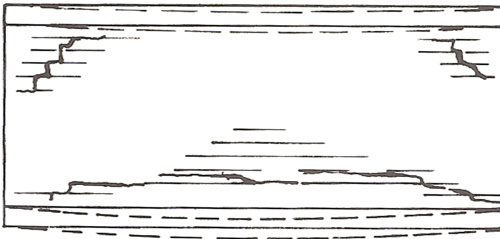
FIGURA 9: TRINCAS EM PAREDE DE VEDAÇÃO: DEFORMAÇÃO DO SUPORTE MAIOR QUE A DEFORMAÇÃO DA VIGA SUPERIOR FONTE: (THOMAZ, 1989)
