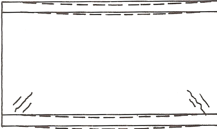
FIGURA 11: TRINCAS EM PAREDE DE VEDAÇÃO: DEFORMAÇÃO DO SUPORTE IDÊNTICA À DEFORMAÇÃO DA VIGA SUPERIOR
