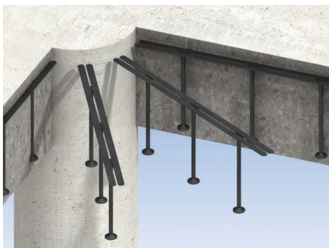
FIGURA 12 – POSIÇÃO DE STUDRAILS EM UMA REPRESENTAÇÃO DE LAJE-LISA
