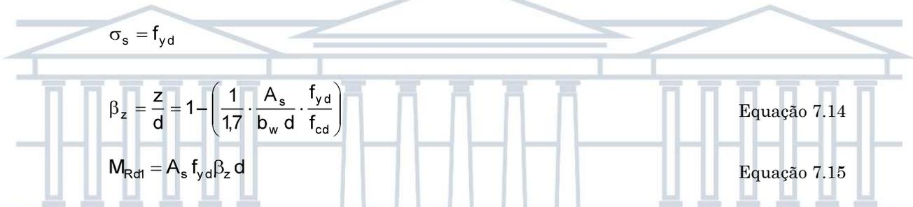
A Equação 7.13 corresponde ao momento fletor resistente de cálculo para barras ancoradas com  $\ell_{b,nec}$  ( $\sigma_s < f_{yd}$ ) e a Equação 7.15 corresponde ao momento fletor resistente de cálculo para barras ancoradas com  $\ell_b$  ( $\sigma_s = f_{yd}$ ). Observar, também, que a Equação 7.13 e a Equação 7.15 estão contidas na Equação [5.18] usada para a determinação de armadura longitudinal de vigas de seção retangular sem armadura de compressão.
