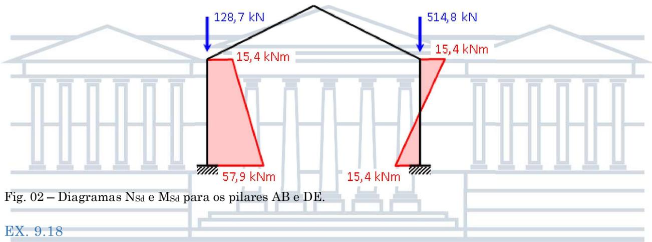
Fig. 02 – Diagramas  $N_{sa}$  e  $M_{sa}$  para os pilares AB e DE.
