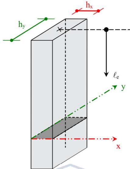
$$I_x = \frac{h_y \times h_x^3}{12} \quad \langle \text{rigidez na direção } x \Rightarrow \text{possível flambagem na direção } x \rangle^{24}$$
