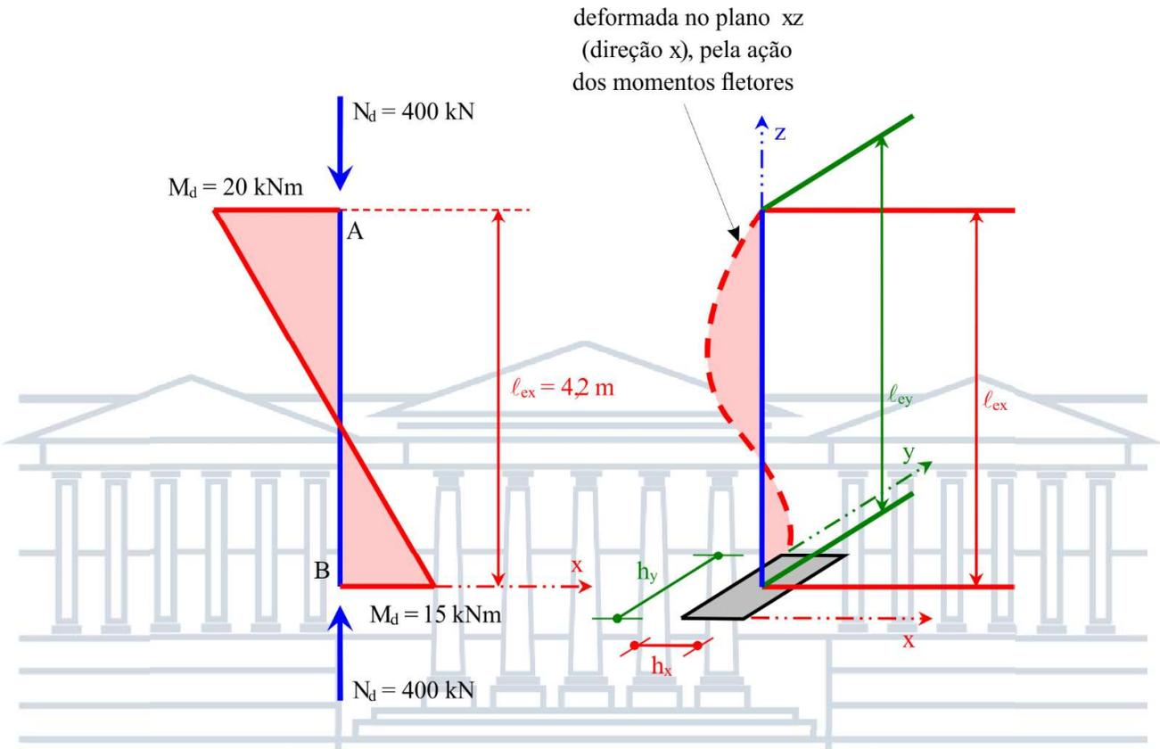
**Solução:** A solução do problema consiste na determinação do valor  $\lambda$ , dado pela Equação 9.11, e no valor  $\lambda_1$ , dado pela Equação 9.12, com  $\alpha_b$  determinado pela Equação 9.14. A comparação entre estes valores define se os efeitos de 2ª ordem devem ou não ser considerados no dimensionamento do pilar. O valor de  $M_{1d,min}$  é dado pela Equação 9.7.
