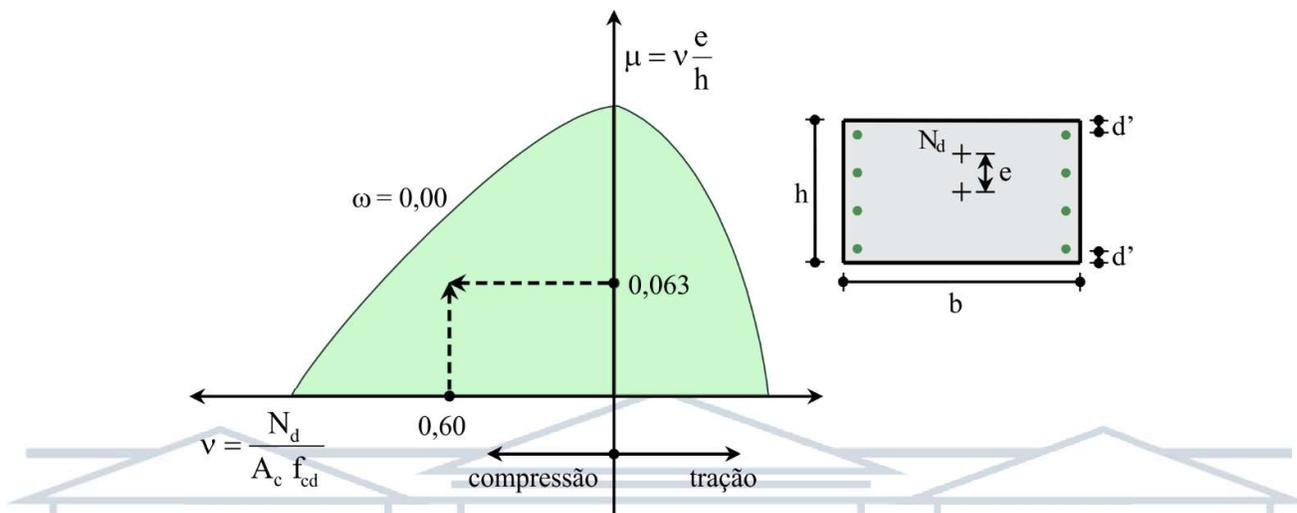
Como o  $\omega$  calculado pela segunda verificação (0,00) resultou inferior ao  $\omega$  da primeira verificação (0,32), prevalece a solução  $\omega = 0,32$  (8  $\phi$  16 mm).
