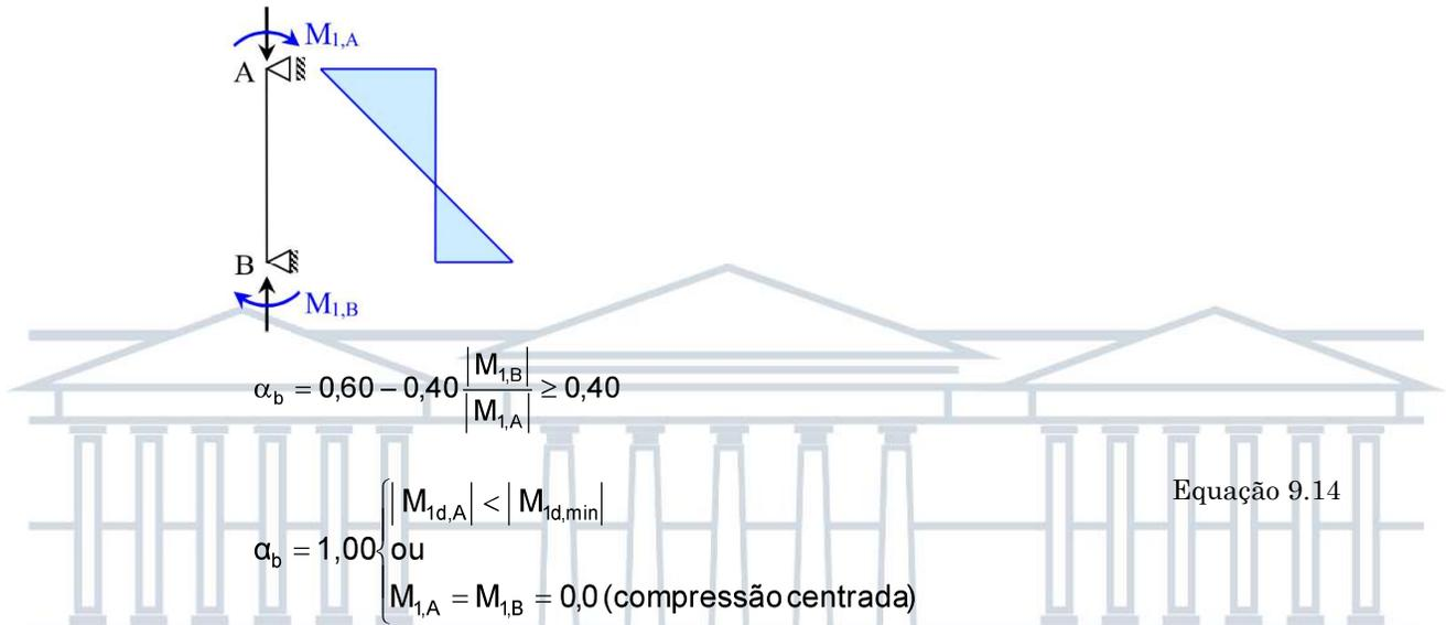
b) pilares biapoiados com cargas transversais significativas ao longo da altura
