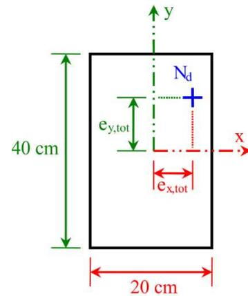
Observar que os sinais dos momentos fletores (sinais das excentricidades) não foram considerados na tabela acima. Isto se deve ao fato da obrigatoriedade do pilar ter seção constante, ser simétrico na geometria e na distribuição de armadura. Desta forma o par de excentricidades pode atuar em qualquer quadrante que, devido às simetrias, o resultado do dimensionamento da armadura será sempre o mesmo.
