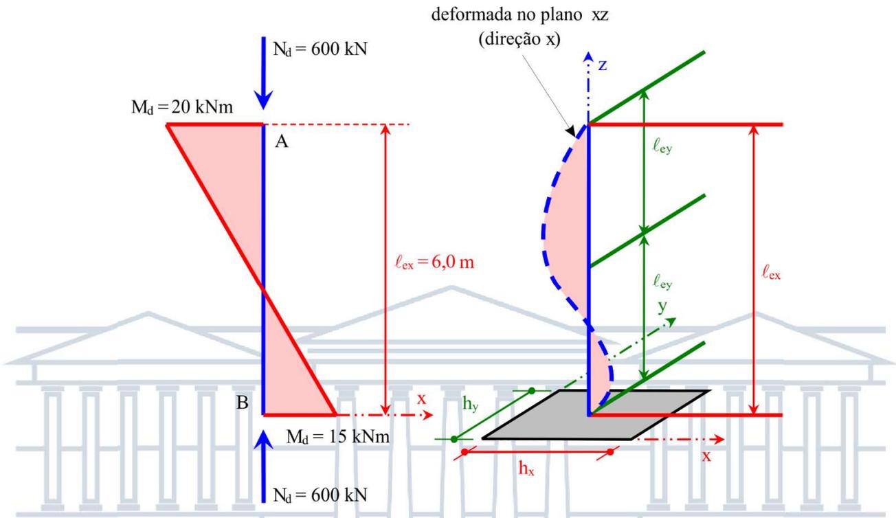
**Solução:** A solução do problema consiste na determinação do valor  $\lambda$  dado pela Equação 9.11 e no valor  $\lambda_1$  dado pela Equação 9.12 para verificar a necessidade, ou não, de serem considerados os efeitos de 2ª ordem. O valor de  $M_{d,tot}$  fica definido pela Equação 9.17 combinada com a Equação 9.18. O valor de  $M_{1d,min}$  é definido pela Equação 9.7.
