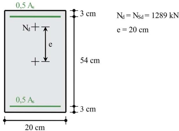
**Solução:** A solução do problema consiste na aplicação direta do ábaco A-1 apresentado em Dimensionamento de Peças Retangulares de Concreto Armado Solicitadas à Flexão Reta, W. S. Venturini, EESC/USP. A armadura mínima deve ser verificada pela Equação 9.22 e a armadura máxima com a Equação 9.23.
