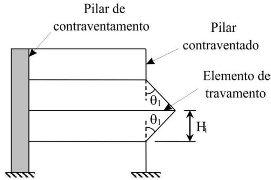
Figura 9.7 – Elementos de travamento (tracionado ou comprimido)
