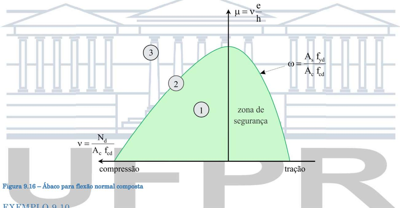
Figura 9.16 – Ábaco para flexão normal composta
