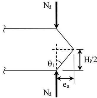
Figura 9.9 – Excentricidade por falta de retinidade de pilar
