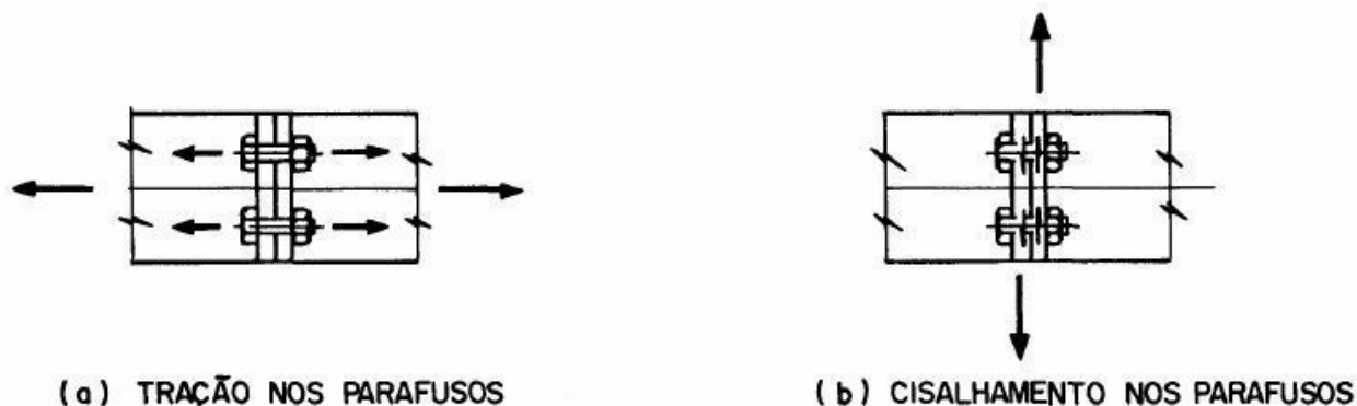
figura 7.9 – Comportamento típico de uma ligação parafusada
