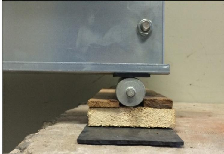
*Figura 21 – Detalhe do apoio rotulado*
