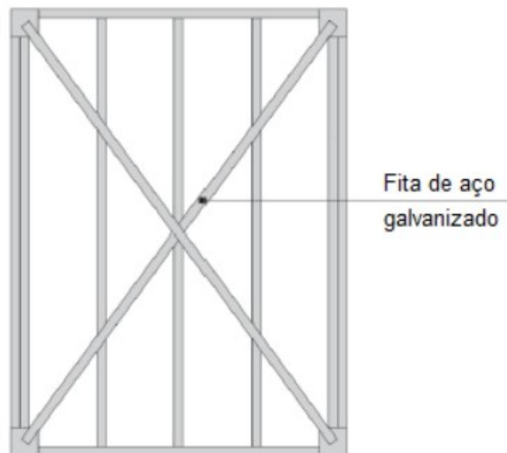
*Figura 4 - Fita metálica para travamento dos painéis do Sistema Light Steel Framing (Fonte: CRASTO, 2006).*
