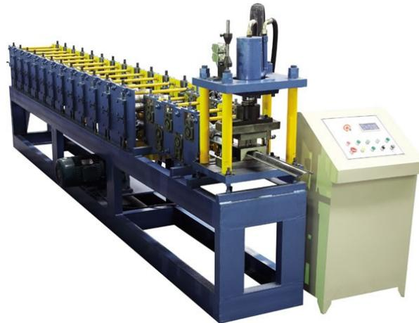
*Figura 7 - Máquina perfiladeira (Fonte: ZHONGYUON).*
