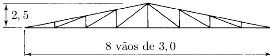
Figura 4.27: Treliça plana de cobertura (em metros).
