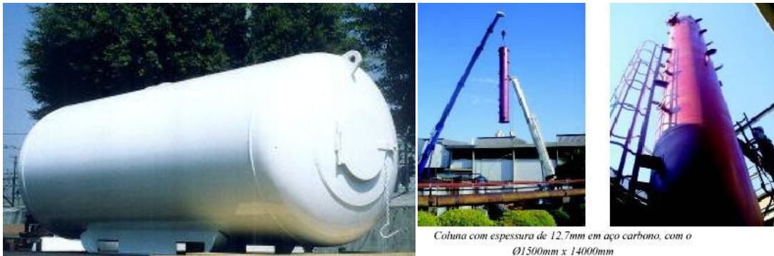
Figura 1 – Exemplos de vasos de pressão (fotos retiradas da internet).
